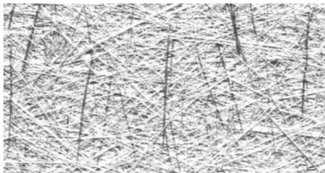
Mat de fibra de vidrio cortada diseñado especialmente para el moldeado por laminación manual. Proporciona un excelente rendimiento.
